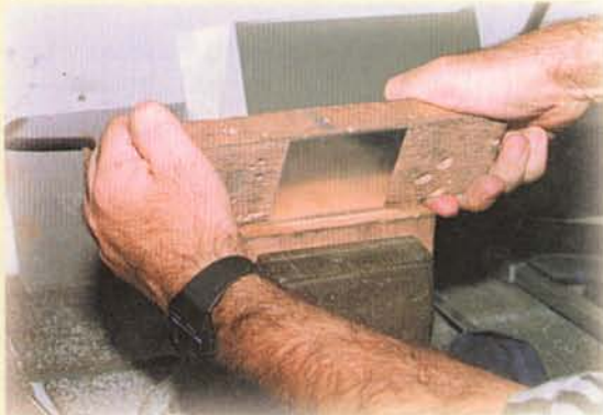
Figura 8.24. También se puede doblar la lámina con una prensa de banco y una pieza de madera
